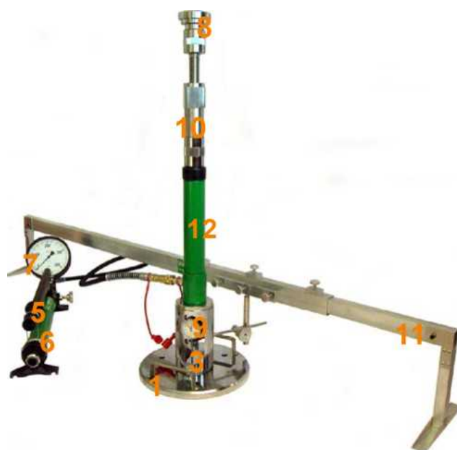
Rys. 1.2 Aparatura VSS z jednopunktowym pomiarem przemieszczenia płyty
